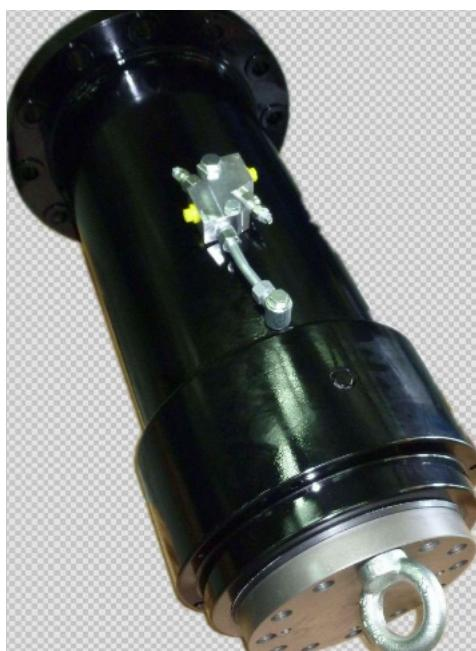
摆动缸主要有以下几种分类：1. 齿轮齿条式：这种油缸是通过直线油缸带动齿条往复运动，从而实现与齿条相啮合的齿轮的摆动。适宜于传递大扭矩、安装简单、使用方便、价格便宜。但是外形尺寸大、占用空间较
